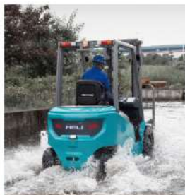
Nach Wassertest von 10 Minuten hat das Fahrzeug keinen Ausfall. (Wassertiefe 200 mm)
