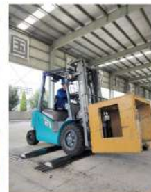
Der Stapler hat das Simulationsexperiment für hohle Straße bestanden.
